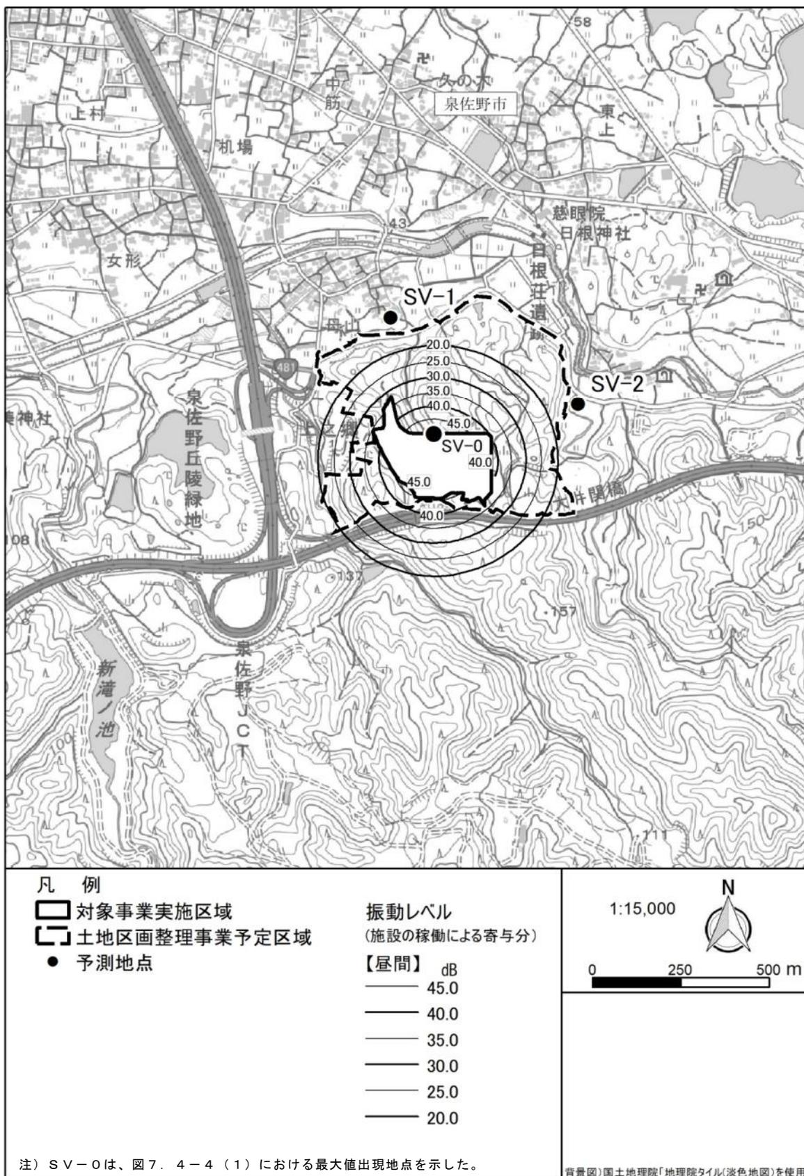
図 7. 4-5 (1) エネルギー回収推進施設等の稼働に伴う施設振動の予測結果 (一般環境 昼間)
